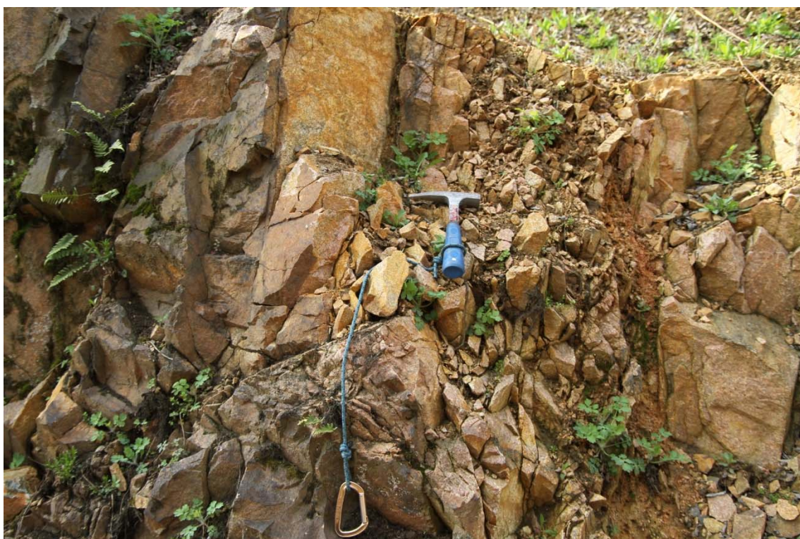
Obrázek 17: detail zvětrání a rozpadu na fragmenty u zářezu jako celku
